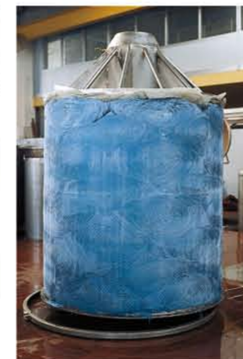
用离心材料装载器的压实毛条染色装置的一部分
