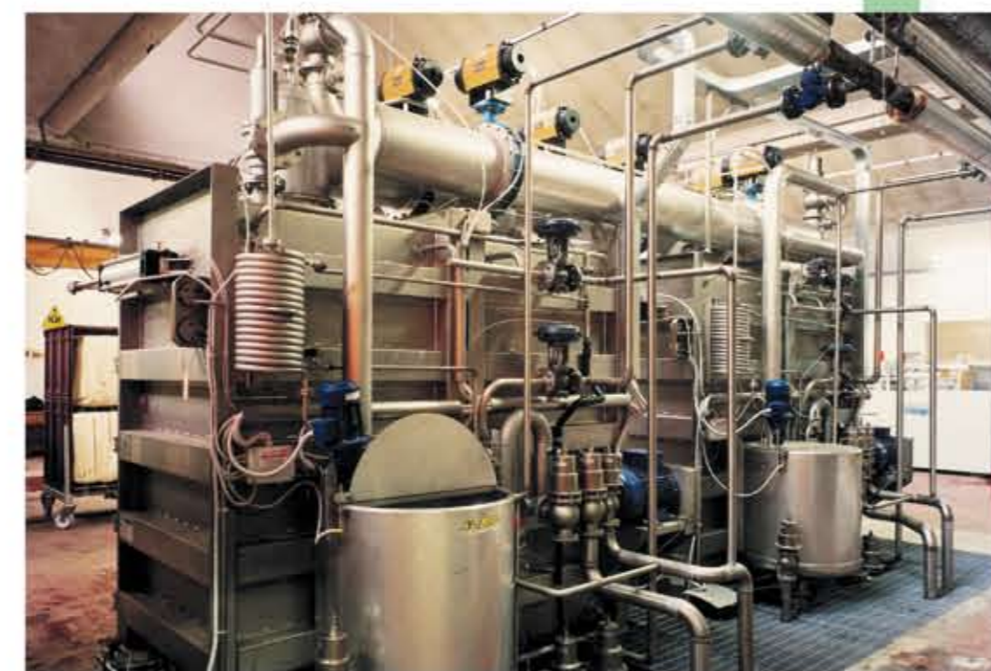
Veduta di un impianto per tintura matasse con apertura/chiusura automatica delle porte e bloccaggio rapido centralizzato.
