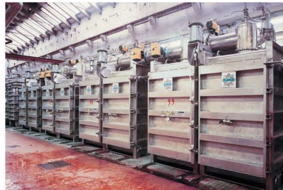
Veduta di un impianto per tintura matasse con apertura/chiusura automatica delle porte e bloccaggio rapido centralizzato.
