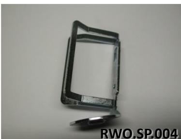
Sensorhalterung mit Schutzbügel (wirkt dem Herausspringen des Fadens aus dem Sensor entgegen und bietet mechanischen Schutz für den Sensor) Geeignet für die Sensoren TS44/1000ERW oder TS44/100DRW, ausgestattet mit Öse BC.0.058 = Ø 6,2 mm
