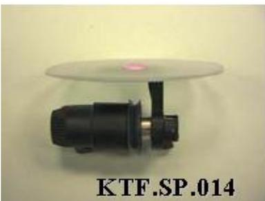
KTF.SP.014 Fadenbremse mit geschlossener Keramiköse und Antiballonscheibe, 0,3 mm Feder (gelber Ring)
