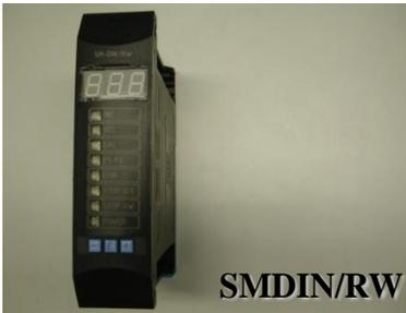
SMART DIN RW. Elektronisches Modul zur Steuerung von KTF/100RW und TS4/100DRW Spannungssensor.
