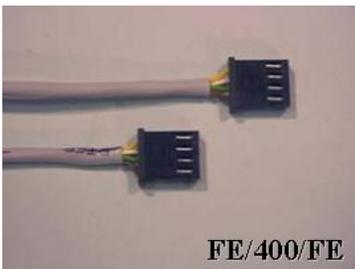
Verbindungskabel 400 cm zwischen SMART MATRIX FEEDER und KTF/PW4 bzw PFU....
