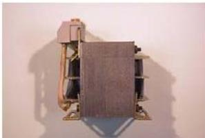
Transformator mit Ausgang 24VAC/300VA für über 40 Sensoren
