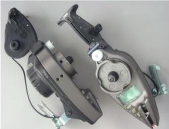
Spezieller Separator, der die Fäden durch Nuten trennt (weißes Teil)
