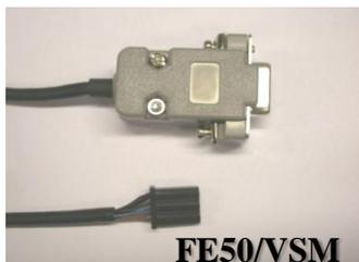
Verbindungskabel zwischen LED- Großdisplay und Conversion Board
