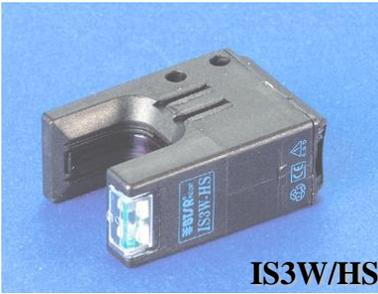
Programmierbarer Sensor IS3W-HS “ IMAGE SMART SCANNING SENSOR “, berührungslose Garnkontrolle, mit touch-light button, CR-Steckbuchse (rot), Multikonnector-Kabel; **Sensor für das System SMART 64 H, dieser Sensor ist inkompatibel zu MATRIX 64 H**
