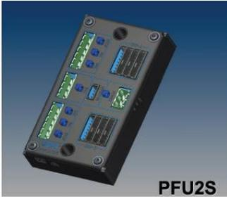
Einfacher Verteiler für die Spannungsversorgung und das Management für 2 Feedergruppen (bis max. 8 Unifeeder)
