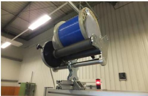
ROLLING MED II- Kontrollsystem für konstante Fadenspannung und -geschwindigkeit vorzugsweise für nacktes Elastomer auf Scheibenspulen oder zylindrischen Spulen
