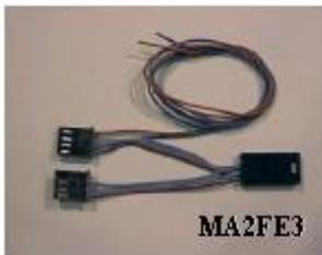
Zweifach- Verbindungskabel mit separatem STOP- und Masse-
