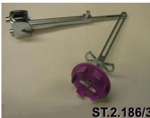
Spezialhalterung für Garnspulen
