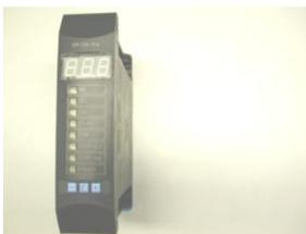
Elektronisches SMART DIN WARP Modul zur Steuerung von IS3F/485 Sensoren
