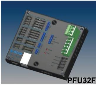
Erweiterter Verteiler für die Spannungsversorgung und das Management für 4 Feedergruppen (bis max. 12 Multifeder)
