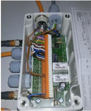
E-BOX –Typ Standard (Innenansicht, zur steckerfertigen Verbindung mit dem Nähautomaten, bei Bestellung bitte den Typ mit angeben)
