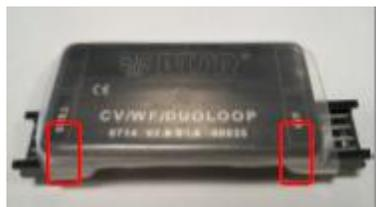
**CV/WF/DUOLOOP** Schnittstellenboard zwischen Sensor und Winding Feeder. Es wird für jeden Winding Feeder ein Board benötigt.
