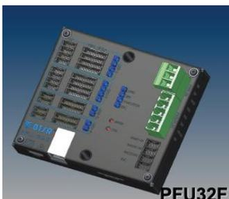
Erweiterter Verteiler für die Spannungsversorgung und das Management für 4 Feedergruppen (bis max. 12 Ultrafeeder)
