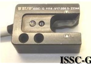
Sensor ISSC... (programmierbar und parametrierbar) für die Kontrolle auf Knoten, Dünnstellen, Dickstellen, fehlende Garne, zuviele Garne und Fadenbruch **ohne Fadenführer aber mit selbstreinigender Optik**
