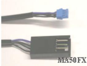
Verbindungskabel zu 1. Sensor FX-Stecker (Länge 50 cm; zur Verbindung zum SMDIN, bitte zusätzlich Kabel FE.../FEC verwenden
