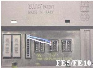
Spezialkabel für die Spannungsversorgung des SMART bei externer Spannungsversorgung über die Sensoren
