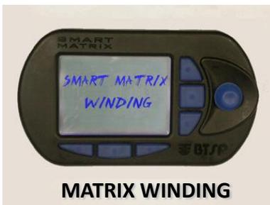
MATRIX WINDING Terminal (optional) für die Programmierung und Kontrolle von bis zu 240 WINDING FEEDERN (Funktionsumfang siehe auch Handbuch oder auf Nachfrage)
