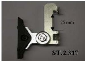
Einstellbare Halterung zur Montage des ULTRAFEEDER am Maschinenring 5 x 25 mm; Befestigung über Klickaufnahme an der Rückseite des ULTRAFEEDER/MULTIFEEDER
