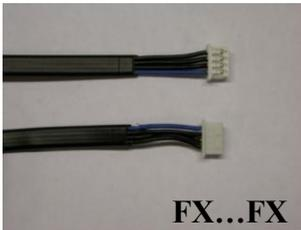
Verbindungskabel für Sensoren IS3F/TS (mit FX-Steckern)
