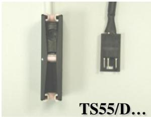
Digitaler Sensor zu Messung der Fadenspannung mit 35 cm Anschlußkabel
