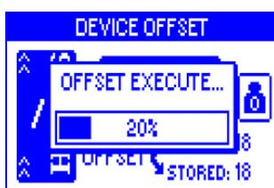
La barre OFFSET EXECUTE indique l'état d'avancement de l'opération (pourcentage de capteurs calibrés).
