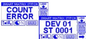
Erreur de comptage (*la quantité des impulsions de tension enregistrées par le capteur 01 n'est pas cela imposée dans le paramètre **STITCH COUNT***).
