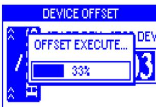
La barre **OFFSET EXECUTE** indique l'état d'avancement de l'opération (*pourcentage de capteurs calibrés*).
