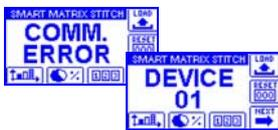
Erreur de communication entre SMART MATRIX STITCH et capteur 01.
